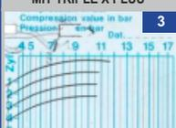
Werkstatttest „Opel Astra“, Kilometerstand 160.000 km, 07/11/2016- Nachweis auf Wirksamkeit im werkstattnahen Anwendungsfall. 3 von 4 Zylindern weisen einen ca. 10% höheren Druck aus. Alle Zylinder haben nach der Anwendung einen annähernd gleichen Wert.
