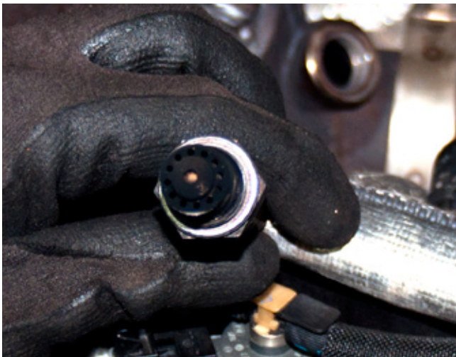
Sensor vor der Reinigung | Probe before cleaning
